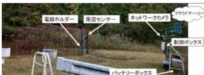
遠隔監視操作システムの概要
