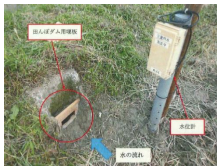
田んぼダム実証実験状況
