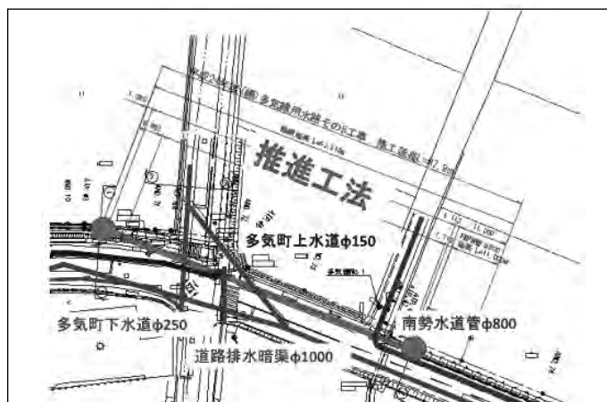
地下埋設物状況図 (fig.2)
